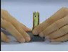
フェライト磁石のN極を上にして置き、その上に単3の乾電池を立てます。
