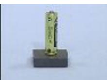
フェライト磁石のS極を上にして置き、その上に単3形乾電池を立てます。
