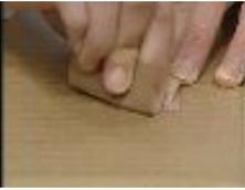
ダンボールを下に敷いて、銅板と亜鉛板の両面をやすりでよくみがきます。
