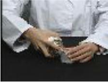
プラスチックカップの隙間からスプレーの噴射口を差し込み、中にコールドスプレーの液体をためます。
