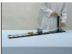
9 レールの位置を順番に変えて、木片の端が目盛りのゼロになうように置き、36gのおもりをフックの位置から同じように落とし、木片の動いた距離と速度をはかります。
