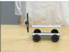
7 車体を手で固定し、プロペラを反時計回りに20回巻いて手を離し動く距離とはやさを観察します。
