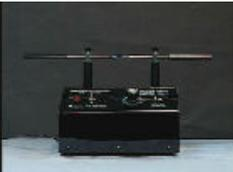
誘導コイルの電源を入れて放電を確認します。
