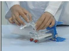
電気分解装置のゴム栓が確実に差し込まれているか確認し、5%の水酸化ナトリウム水溶液100mlを、裏面からろうとを使って入れ、さらに装置を傾け、前面の槽に水溶液を満たします。
