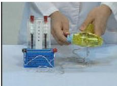
水槽に手回し発電機をつなぎ、手回し発電機のハンドルを回して、水槽内に気体が発生していることを確認します。
