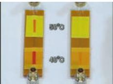
発熱実験器の2つのスイッチを同時に「ON」にして、2種類の電熱線のあたたまり方のはやさや温度を確認し、実験後はすぐにスイッチを「OFF」にします。
