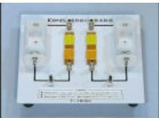
発熱実験器の太さのちがう電熱線が切れていないことを確認し、電熱線の上に2種類のサーモテープをそれぞれはさみで切ってはります。
