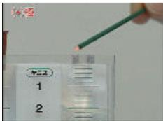
プラス側につないだ電気分解装置のゴム栓を開けると同時に、火をつけた線香を近づけてようすを観察します。
