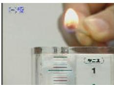
マイナス側につないだ電気分解装置のゴム栓を開けると同時に、マッチの火を近づけてようすを観察します。
