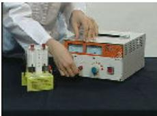
電気分解装置と直流電源装置をみの虫リード線でつなぎます。
