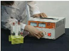
直流電源装置の電源を入れて6Vにし、水溶液のようすを観察し、気体が、目盛2まで発生したら、直流電源装置の電源を切ります。
