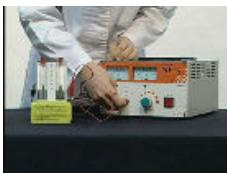
電気分解装置と直流電源装置をみの虫リード線でつなぎます。
