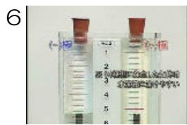
6 プラス側につないだ電気分解装置のゴム栓を開けて、サインペンで色つけたろ紙を近づけてようすを観察し、同時に臭いを確認します。
