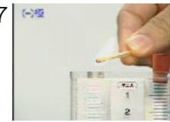
7 マイナス側につないだ電気分解装置のゴム栓を開けると同時に、マッチの火を近づけてようすを観察します。
