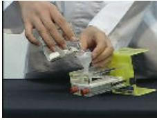
電気分解装置のゴム栓が確実に差し込まれているか確認し、7%の塩酸100mlを、裏面からろうとを使って入れ、さらに装置を傾け、前面の槽に塩酸を満たします。
