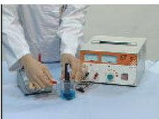
炭素電極、直流電流計と直流電源装置をみの虫リード線でつなぎます。
