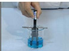
10%の塩化銅水溶液をビーカーに入れ、炭素電極を塩化銅水溶液につけます。
