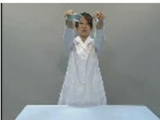
片方のアルミ容器を丸め、同じ高さから落とします。
