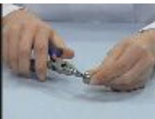
のばしたクリップを丸オモリの穴に通し、抜けないように片方を曲げます。
