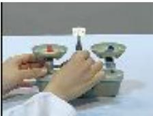
調整した上皿てんびんの左右の皿に別の風船をのせ、つりあうように再び調整します。
