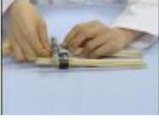
セロハンテープで電池をフィルムケースに固定します。
