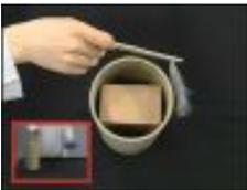
レンガに円柱形の紙管をかぶせて、30cm離れたところからドライヤーで冷風を送り、ミニ吹流しで、紙管の周りの空気の流れを観察します。
