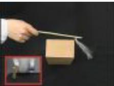
レンガを縦に置き、30cm離れたところからドライヤーで冷風を送り、ミニ吹流しで、レンガの周りの空気の流れを観察します。
