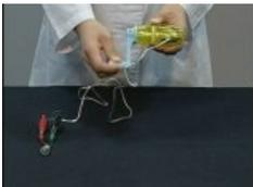
出力制御付き手回し発電機に1.5Vのまめ電球をひとつつなぎ、ハンドルをゆっくりまわして、まめ電球のようすを観察します。
