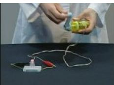
5 出力制御付き手回し発電機のハンドルを右にゆっくりまわし、LEDの明るさとハンドルの重さを確認します。
