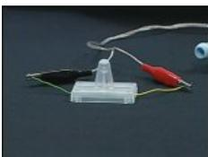
3 台付LEDの黄色い導線を出力制御付き手回し発電機の赤のクリップに、緑色の導線を黒のクリップにつなぎます。
