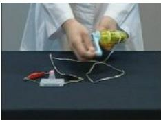
出力制御付き手回し発電機のハンドルを左にゆっくりまわし、LEDの明るさとハンドルの重さを確認します。
