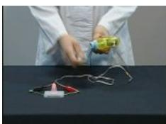
手回し発電機のハンドルを右に普通にまわし、LEDの明るさとハンドルの重さを確認します。
