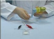
出力制御付き手回し発電機のハンドルを左にまわし、電子メロディーの音を確認します。
