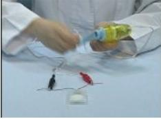
手回し発電機のハンドルを左にまわし、電子メロディーの音を確認します。
