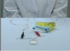
手回し発電機の赤のクリップに、電子メロディーの赤の導線、黒のクリップに黒の導線をつなぎます。
