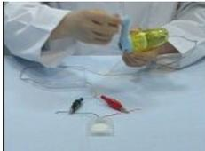
出力制御付き手回し発電機のハンドルを右にまわし、電子メロディーの音を確認します。
