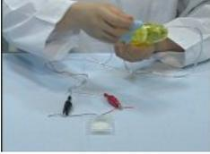
手回し発電機のハンドルを右にまわし、電子メロディーの音を確認します。
