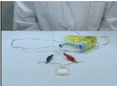
出力制御付き手回し発電機の赤のクリップに、電子メロディーの赤の導線、黒のクリップに黒の導線をつなぎます。
