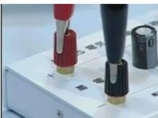
蓄電側の赤色の端子に出力制御付手回し発電機の赤のクリップを、黒色の端子に黒のクリップをつなぎます。
