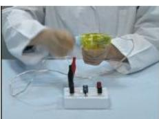
出力制御付手回し発電機のハンドルを300回まわし、スイッチを「OFF」にしてクリップをはずします。
