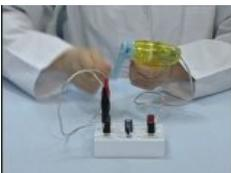
手回し発電機のハンドルを40回まわし、スイッチを「OFF」にしてクリップをはずします。
