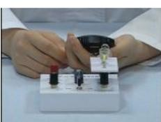
スイッチを「放電」にし、まめ電球がついてから消えるまでの時間をはかり、スイッチを「OFF」にしてまめ電球をはずします。
