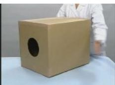
強い勢いのうず輪を作るための「たたきうち」は、梱包用テープ（ガムテープ）で閉じていない方のダンボール箱の側面を強くたたきます。
