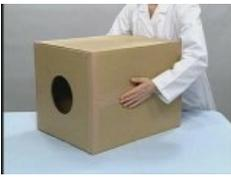
うず輪の動きをゆっくりと見るための「押しうち」は、梱包用テープ（ガムテープ）で閉じた方のダンボールの側面を押しようにしてうちます。
