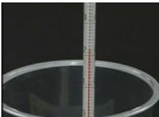
水の中の乾燥剤に温度計をつけ、温度の変化を観察します。
