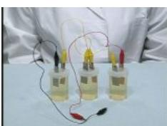
28 電子メロディーの赤と黒の導線に、みの虫クリップをつなぎ、音がなるか確認します。
