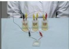
電子メロディーの赤と黒の導線に、みの虫クリップをつなぎ、音がなるか確認します。
