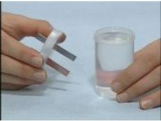
キャップ付ケースのふたに銅版と亜鉛板を差し込み、食塩水の入ったケースにふたをします。
