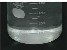
食塩がわずかに溶け残るくらいになったら、水溶液をしばらく放置し、溶けの残りを完全に沈ませます。
