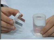
キャップ付ケースのふたに銅版と亜鉛板を差し込み、精製水の入ったケースにふたをします。
