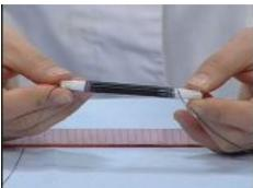
ストローにエナメル線を100回巻き、巻き始めと巻き終わりは20cmずつのばしてセロハンテープで固定しておきます。
