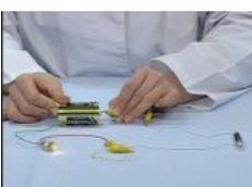
コイルに乾電池と豆電球をつなぎ、電流が流れることを確認します。
