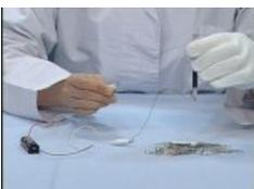
みの虫クリップの片方はずし、釘をさしこんだコイルのようすを観察します。
