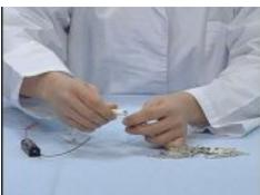
コイルを100回巻いたストローの中に釘をさしこみ、1個用電池ボックスのみの虫クリップにつなぎます。
