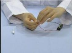
乾電池を電池ボックスに入れ、1個用電池ボックスの導線にみの虫クリップの導線をつなぎます。
