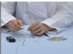
コイルを100回巻いたストローの中に釘をさしこみ、2個用電池ボックスのみの虫クリップにつなぎます。
