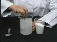
500mlの水が入ったビーカーに、大さじの計量スプーン8杯分の食塩を少しずつ入れて溶かします。
