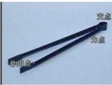
火ばさみの支点、作用点、力点の位置を確認します。
