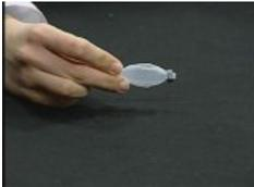
魚の形をしたたれ瓶のふたをはずし、口の部分に六角ナットをはめ込みます。
