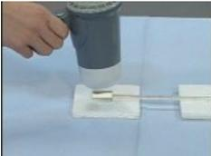
金属ナットにドライヤーで温風をあて、約70℃まで温度をあげます。
