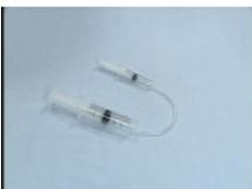
注射器の先にチューブを取りつけて、注射器どうしをつなぎます。
