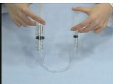
チューブで連結した大小の注射器を押し比べ、どちらが押しやすいかを確認します。
