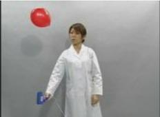
4 風船が真上に浮いた状態で、ドライヤーをゆっくり平行に動かし、風船のようすを観察します。
