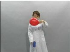
3 ドライヤーを真上に向けて冷風を送り、横から風船を近づけて手をはなし、ようすを観察します。
