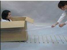
1人が段ボール箱の中に入り、もう1人が段ボール箱を引っ張り、箱が動くときの力の大きさを確認します。
