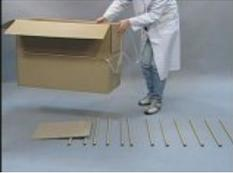
紙管の端に板をかけ、その上に段ボール箱を置きます。
