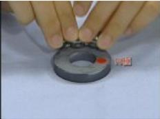
リング型磁石のN極を上にして、鉄球を3つ同時にのせて、ようすを観察します。
