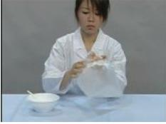
ポリ袋にドライアイスの粉を入れ、口を持って軽く振り、袋を膨らませ、曲がるストローの短い方をさし込みます。
