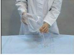
石灰水にストローの長い方をさし込み、袋を押して中の気体をだして、ようすを観察します。
