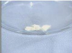
3 0.7gの酸化カルシウムをビーカーに入れ、0.7gの水をスポイトで少しずつ滴下し、しばらく放置します。
