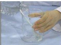
5 ビーカーに水を400ml入れてよく混ぜ、しばらく放置し、石灰水の上澄み液を別ビーカーにとります。
