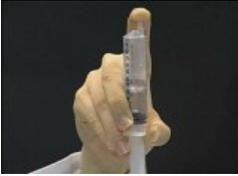
注射器の先を指で押さえて密閉し、ピストンを勢いよく引っ張り、お湯のようすを観察します。
