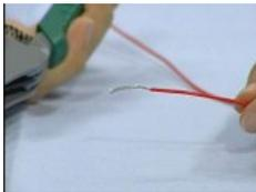
30cmに切った導線の片方を、ワイヤーストリッパーでむき出しにします。
