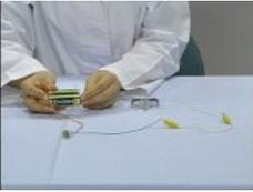
簡易検流器に乾電池と豆電球をつなぎ、電気が流れることを確認します。
