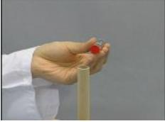
紙管の上からネオジウム磁石を落として、検流器の針の動きを観察します。
