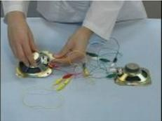
みの虫クリップをスピーカーの端子につけ、2個のスピーカーをつなげます。
