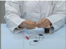
エナメル線の両端を竹串に3回巻いてバネ状にし、両端にみの虫クリップをつけます。
