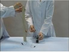
フィルムケース付コイルの片方だけの虫クリップを乾電池プラス極につけたりはなして、LEDのようすを観察します。
