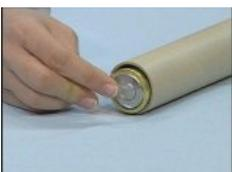
電池のマイナス極に、両端をむきだしにした20cmのビニル線をセロハンテープではります。
