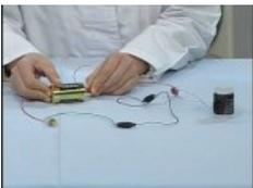
コイルを乾電池と豆電球につなぎ、コイルに電流が流れることを確認します。
