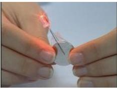
LEDの長い方の線をボタン電池のプラス、短い方の線をマイナスにつなぎます。
