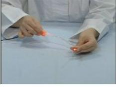
束ねた光ファイバーの先にLEDをつけ、光ファイバーの反対の先から光が出ていることを確認します。
