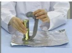
4 電池を2段に重ねて持ち、スチールウールのもう片方を乾電池のプラス極につけます。
