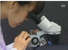
粗動ネジをゆるめ、鏡筒を上下させ、両目でおよそのピントを合わせます。
