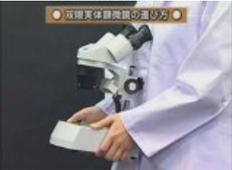
双眼実体顕微鏡を両手で持ち、体に密着させて運びます。
