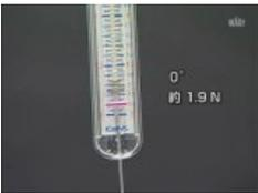
ばねの先端が、基点の位置にきたとき、ニュートンばねばかりの値を読みます。
