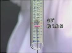
実験用ばねの先端が、基点の位置にきたとき、ニュートンばねばかりの値を読みます。
