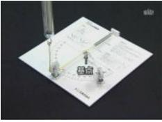
実験用ばねを取り付け、フックに糸を通し、 $0^\circ$  に角度を調節し、1本のニュートンばねばかりを取り付け、実験用ばねの先端が、基点の位置にくるまでニュートンばねばかりを引張ります。
