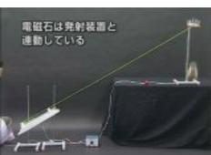
発射すると同時に電磁石の通電が遮断され、サルが落下する仕組みになっています。
