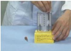
白金めっき付チタン電極がついたゴム栓を、実験器の上部に、しっかり差し込みます。
