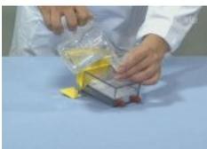
ろうとを使って、薄い水酸化ナトリウム水溶液を100ml入れます。
