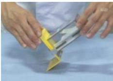
装置の前面に空気が入らないように注意して、装置を立てます。
