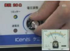
電源装置を操作し、20Ωの抵抗に接続している、直流電圧計が1Vになるよう調節します。
