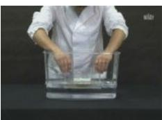
石膏を固めるため、実験器の下側から水が染み込むよう、水が入った大きな水槽にゆっくりと沈めます。
