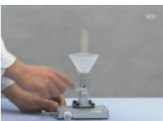
発射レバーを倒すと、発射装置に内蔵されたバネによって、プラスチック球が真上に飛び出します。
