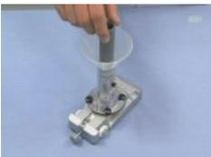
押し込み棒でプラスチック球を押し込み、発射レバーを上げて固定します。
